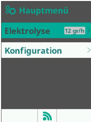
Das Menü Elektrolyse erlaubt alle Einstellungen, die die Chlorproduktion betreffen.
